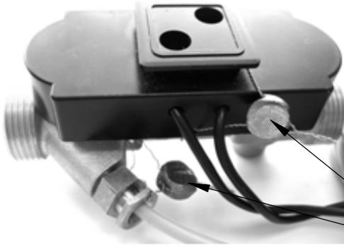
Пломба изготовителя или пломба с нанесенным знаком поверки или пломба организации, установившей теплосчетчик
