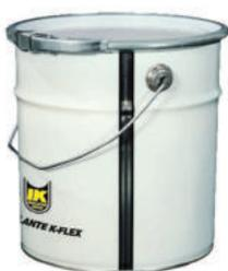
Акриловая краска на водной основе, без запаха, легко наносится и быстро сохнет, не загрязняет окружающую среду и не выцветает. Используется для покрытия изоляции как внутри помещения, так и снаружи. Выпускается объемом 2,5 л. Расход краски 0,45-0,5 л/м<sup>2</sup> в два слоя. Транспортиро-
